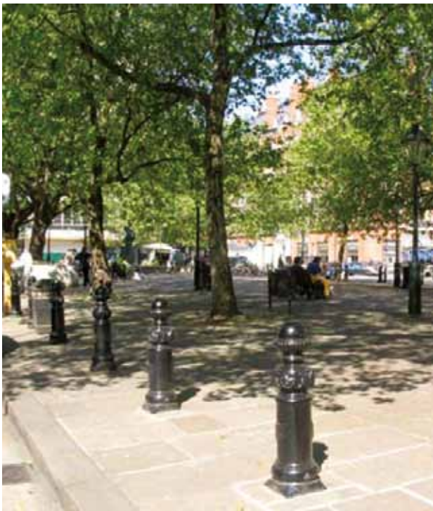
Stubići koji su postavljeni sa međusobnim razmakom manjim od 2m ograničavaju pristup vozilima.
