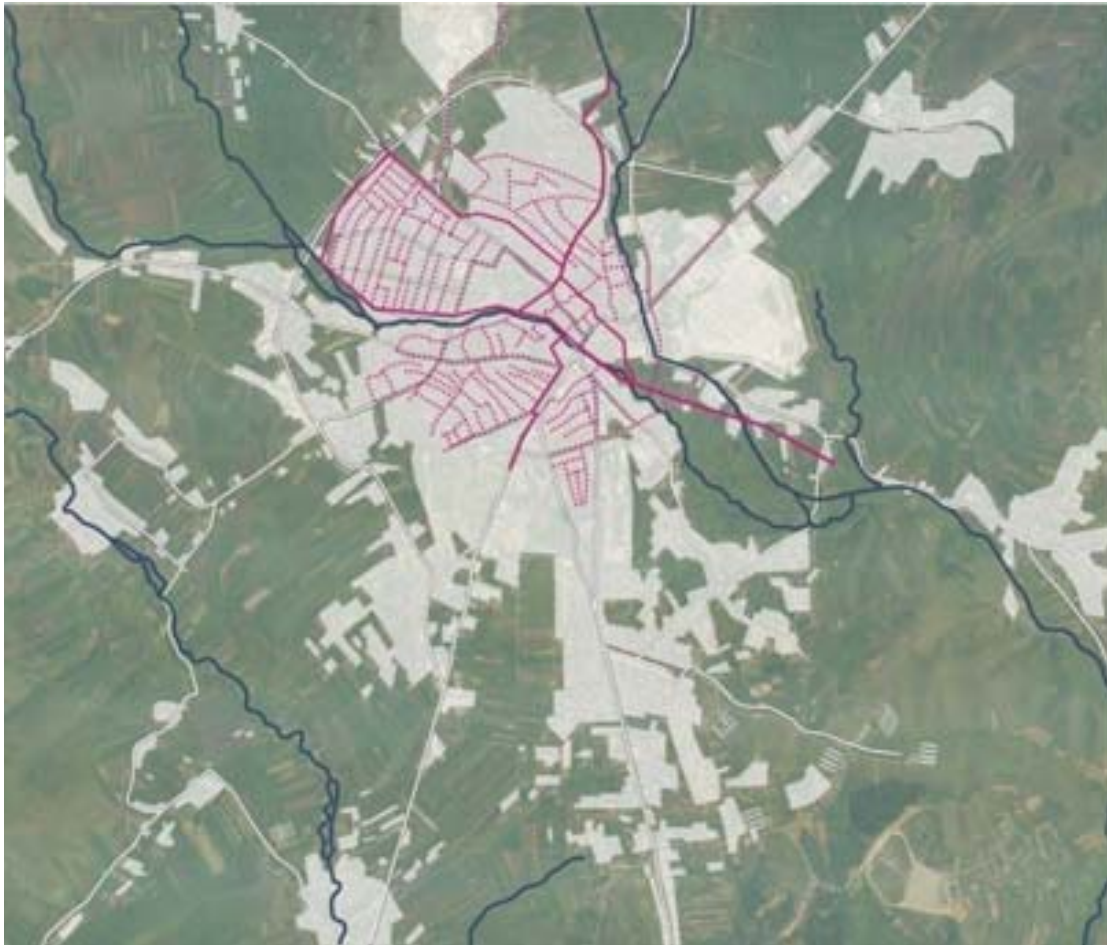
Fig. 24: Shtirja hapësinore e rjetit të kanalizimit
